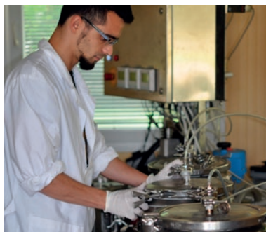
Szilárd fázisú fermentorok üzembe helyezése
